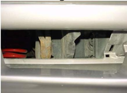
8. Nach erfolgter Lackierung empfehlen wir den Spoiler in dem gekennzeichneten Bereichen umlaufend mittels PU-Kleber mit dem Stoßfänger zusätzlich zu verkleben.
